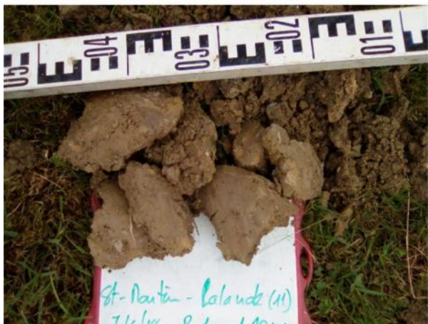
Sol en place relevé à 0.95 m / TN
